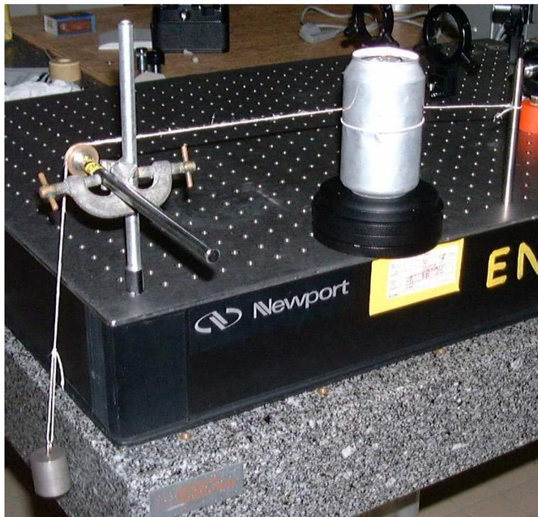
FIG. 5 – Système de contrainte de la canette avec poulie
