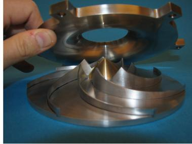
Fig 3.12 – Pompe centrifuge optimisée pour l'expérience Toupie, en cours d'assemblage (ici posée à l'envers).
