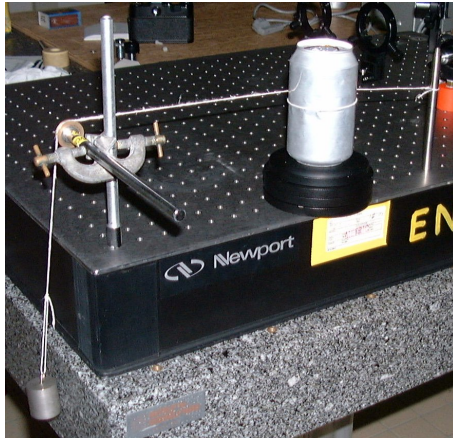
Figure: Système de contrainte de la canette avec poulie
