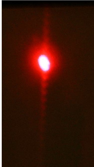
FIG. 3 – Figure de diffraction du microlevier
